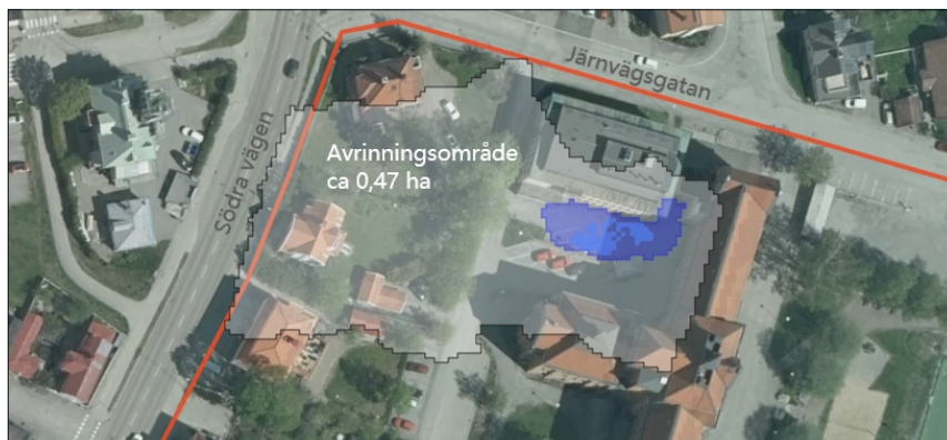
Figur 32. Instängt område på inngård. Simulerad översvämning vid 100-årsregn i 10 minuter (ca 40 mm regn). Vit yta redovisar avrinningsområdet till lågpunkten/instängda området.
