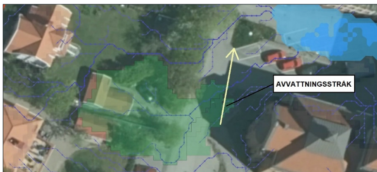
Figur 33. Avvattningsstråk för att kunna avleda grönt avrinningsområde till grönyta.
