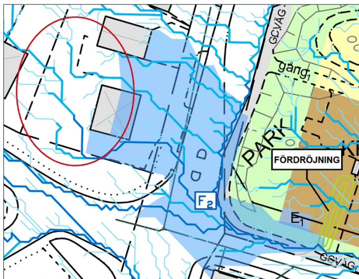
Figur 23. Dagvattenlösning inom delområde F1. Rinnväg inom röd markering kan tillkomma beroende på utformning av kvartersmark.
