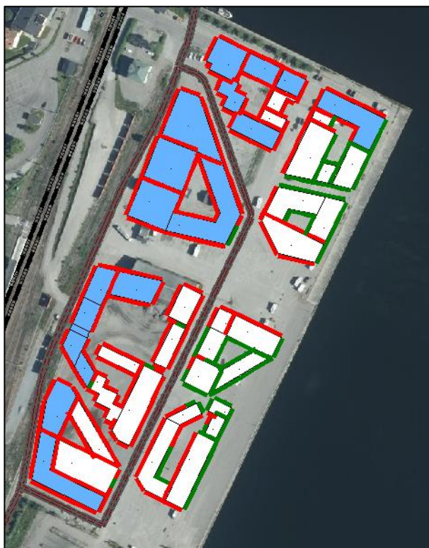
Figur 14. Maximala ljudtrycksnivåer, vid röd fasad överstiger ljudtrycksnivån 70 dBA och vid grön fasad beräknas ljudtrycksnivån till lägre än 70 dBA. De blå husen markerar de byggnader där den ekvivalenta ljudtrycksnivån överstiger 60 dBA vid minst en fasad.
