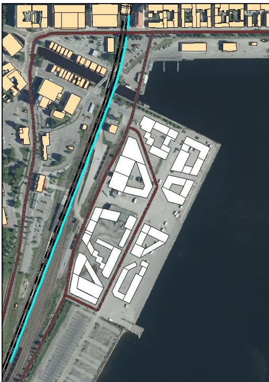
Figur 7. Placering av bullerskärmar längs dubbelspår. Den turkosa linjen markerar bullerskärmar. De vita husen markerar byggnaderna som exploateringen på Kattvikskajen avser.
