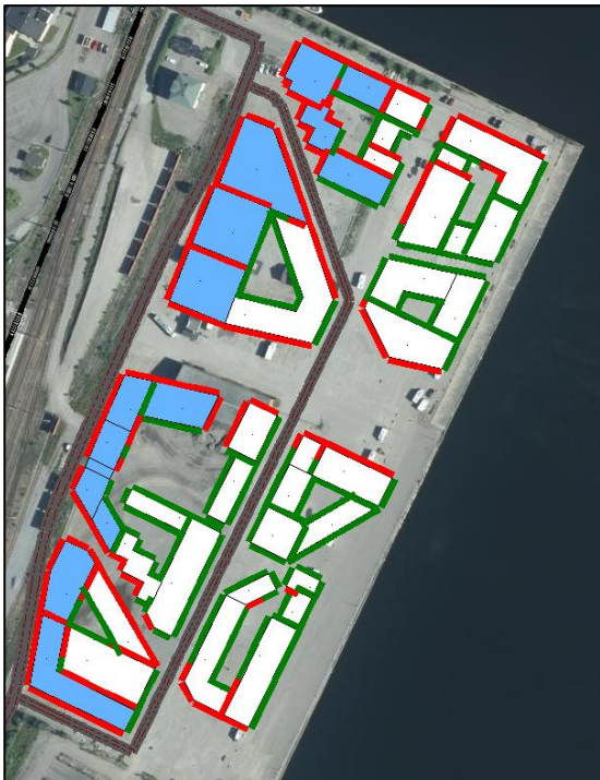
Figur 9. Maximala ljudtrycksnivåer, vid röd fasad överstiger ljudtrycksnivån 70 dBA och vid grön fasad beräknas ljudtrycksnivån till lägre än 70 dBA. De blå husen markerar de byggnader där den ekvivalenta ljudtrycksnivån överstiger 60 dBA vid minst en fasad.
