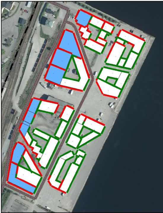
Figur 8. Maximala ljudtrycksnivåer, vid röd fasad överstiger ljudtrycksnivån 70 dBA och vid grön fasad beräknas ljudtrycksnivån till lägre än 70 dBA. De blå husen markerar de byggnader där den ekvivalenta ljudtrycksnivån överstiger 60 dBA vid minst en fasad.
