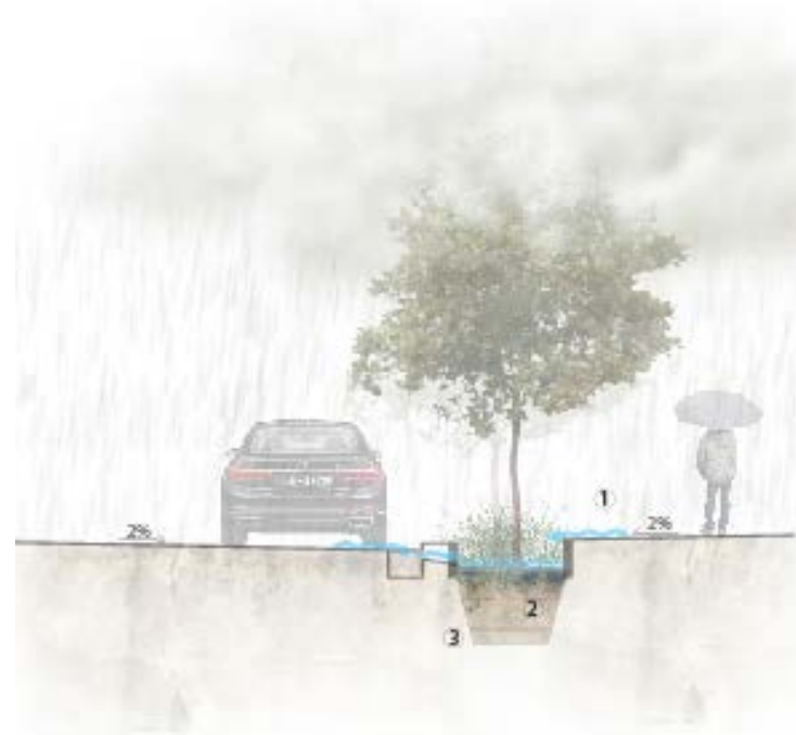
Figur 2 Illustration över tilltänkta regnbäddar. 1) Dagvatten rinner från gata och trottoar ner i regnbädden. 2) Vatten suges upp av växter och träd och renas från föroreningar. 3) Dräneringsrör leder överskottsvatten till befintligt ledningsnät.
