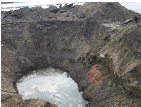
Bild 1 och 2. Provgropar inom planområdet som visar fyllningsmassor som lämpar sig väl för rening och infiltration.
