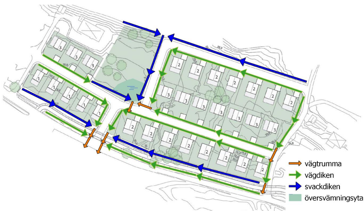
Figur 5 Översiktligt förslag på dagvattenhantering inom utredningsområdet. Svackdiken i norr omhändertar vatten som rinner in på utredningsområdet samt från intilliggande skogsmark, medan svackdiken i söder tar hand om och avleder dagvatten från den södra delen av utredningsområdet. Det öppna fördröjningsmagasinet fördröjer och renar dagvatten från den norra delen av utredningsområdet
