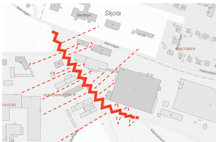
Figur 5. Schematisk illustration över hur buller från Köpmanbergsvägen reduceras innan det når bostäder. Tjock röd linje redovisar bullerkällan, streckade linjer spridningen.
